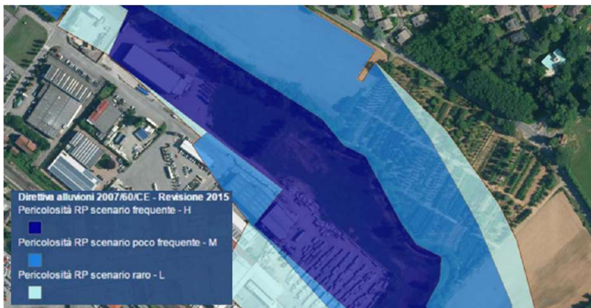
Mappatura della pericolosità del territorio occupato dallo stabilimento ai sensi della Direttiva alluvioni 2007/60/CE - Agg. 2015
